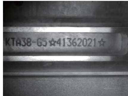
缸体打标站点：字符提取判断合格
