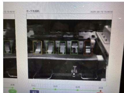
缸套密封圈站点：密封圈漏装拦截
